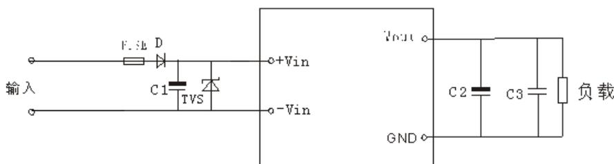
1、瞬态抑制二极管 TVS 与保险丝 FUSE 配合使用可以做到过压保护和防浪涌等功能。保险丝 FUSE 的选取一般在额定输入电流的 1.5~2 倍之间。瞬态抑制二极管 TVS 一般推荐选取“1.5KE170A”即可。
