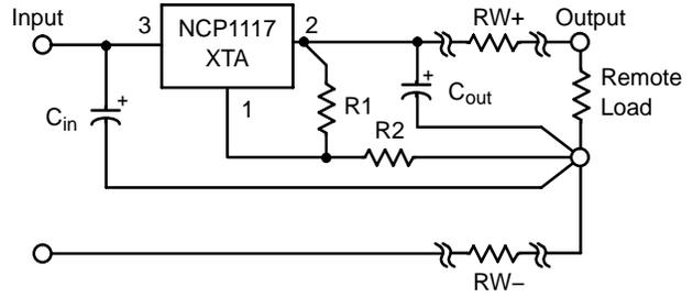
**Figure 23. Load Sensing**
