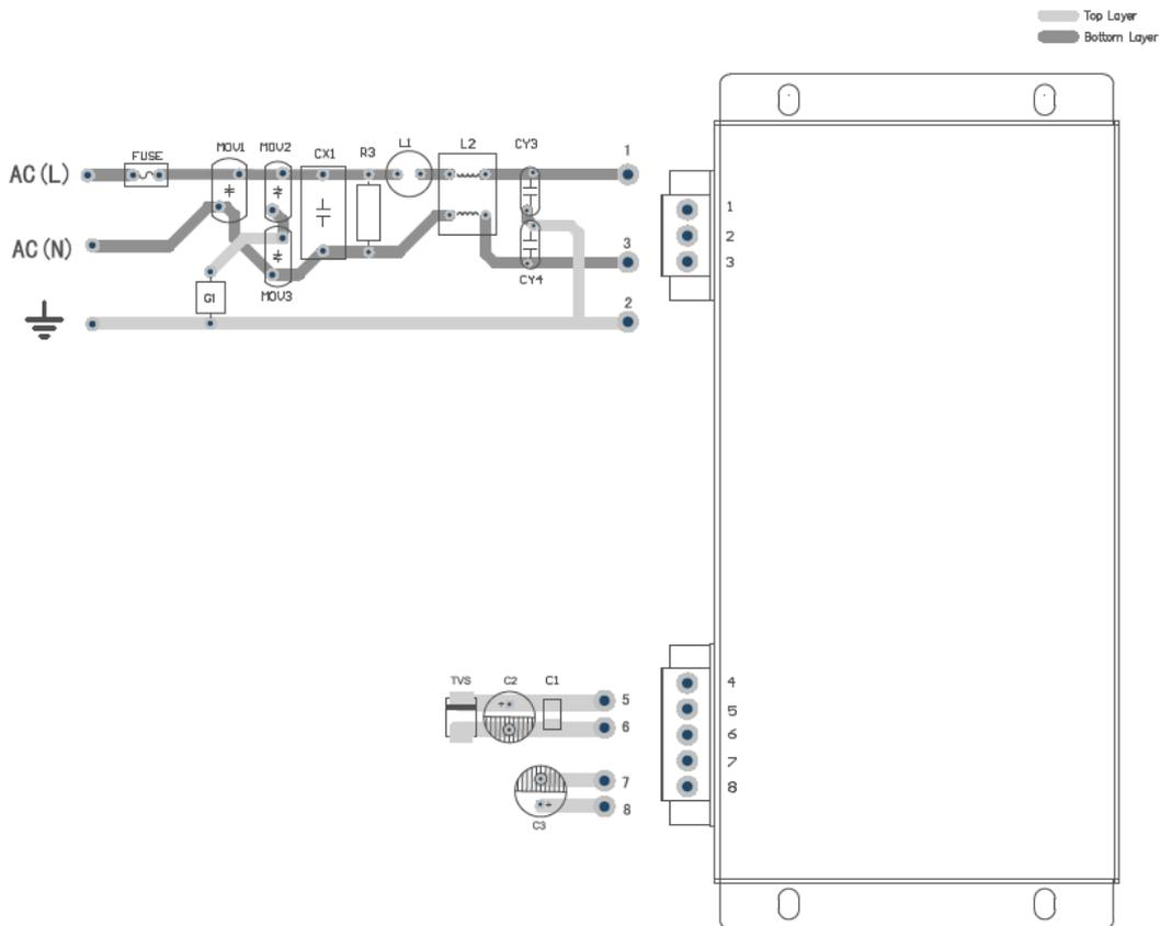
图 3： EMC 推荐电路 PCB 布板图
