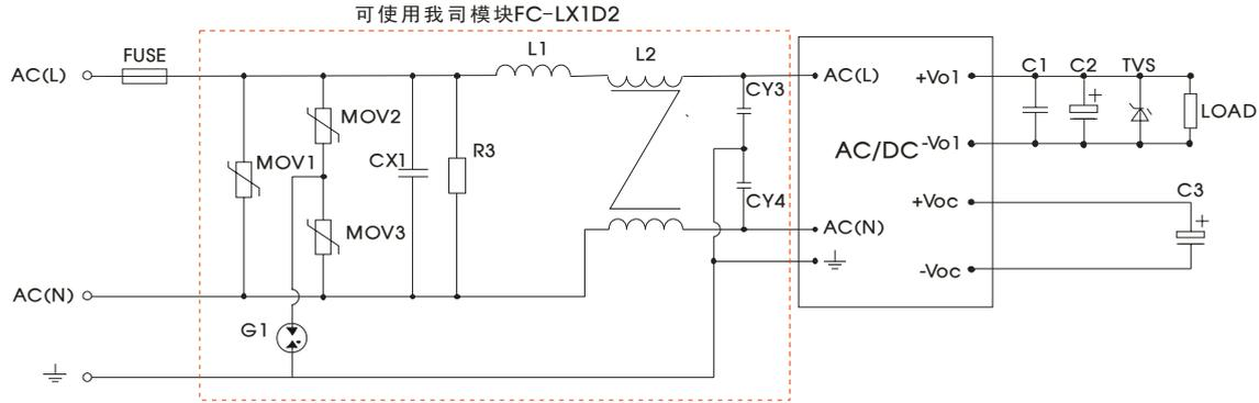
图 2： EMC 更高要求推荐电路
