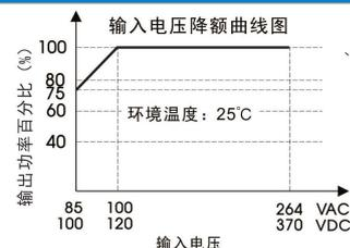
注: ①对于输入电压为 85-100VAC/100-120VDC, 需在温度降额的基础上进行电压降额;
