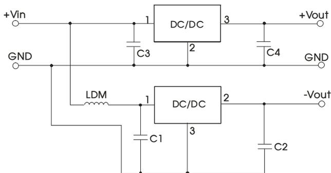
图 3 正负输出并联应用电路
