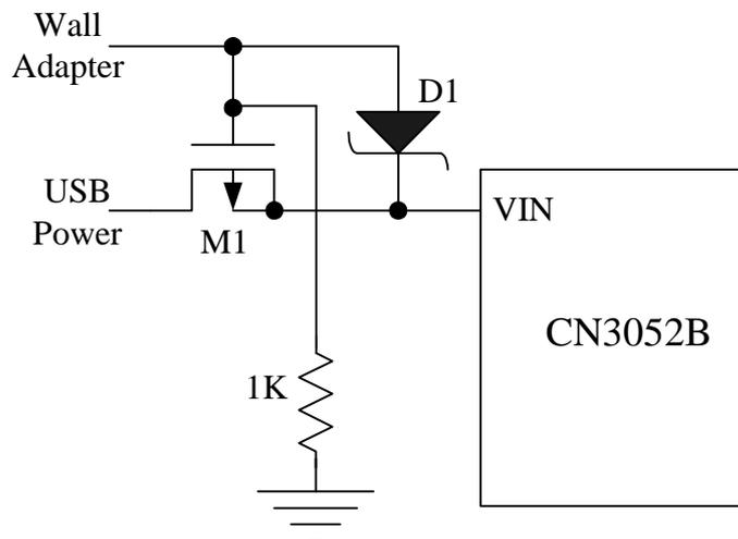
图4 同时使用墙上适配器和USB接口
