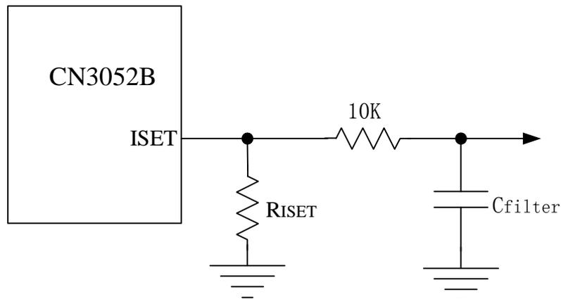
图5 隔离ISET管脚的电容负载
