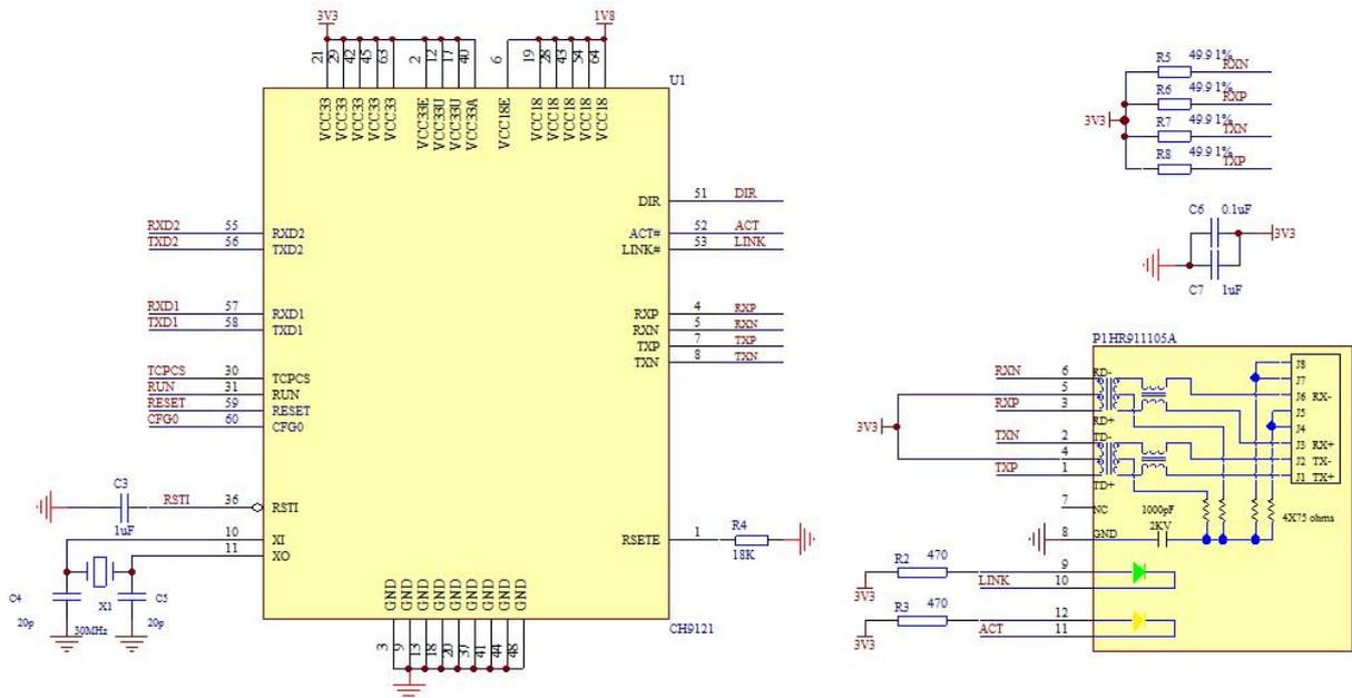
注：由于篇幅限制，图中省略了电源及 3.3V，1.8V 引脚附近退耦电容部分电路，进行电路设计时务必添加到电路中去，详细电路参考文件：CH9121PCB（请至我司官网下载）。
