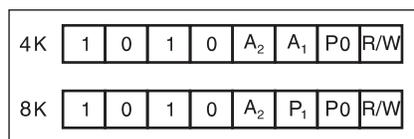
Figure 8-2. Byte Write
